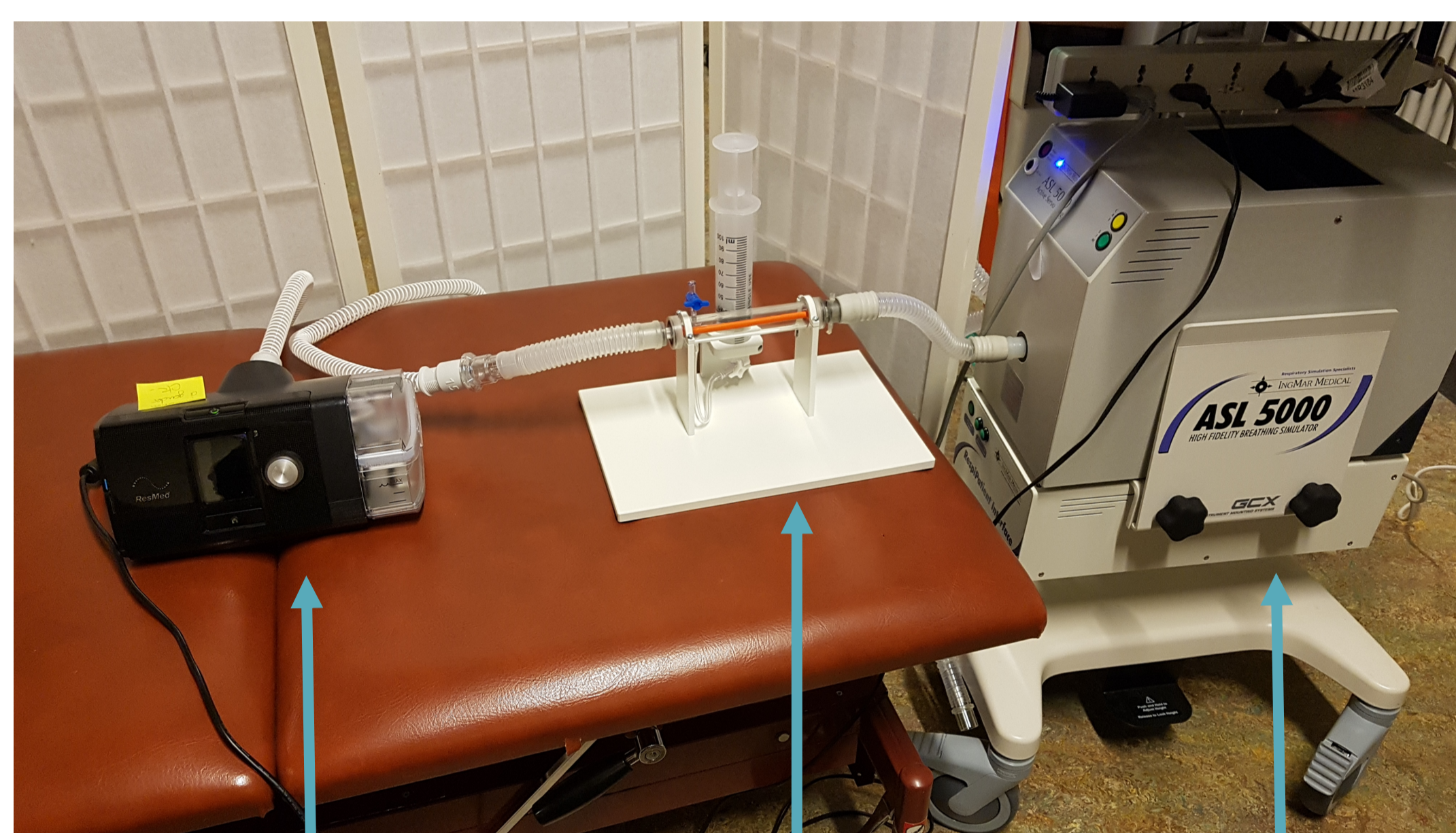
APAP AirSense Autoset 10 Respméd® Résistance de Starling développé en collaboration avec la HEIG-VD (Pr. Staderini) ASL5000
